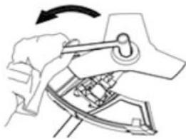
Para el ajuste de ciertos elementos de corte se usa una tuerca de apriete en el cabezal. Ésta se aprieta en contra del sentido de las agujas del reloj y en contra del sentido de giro del cabezal. Para aflojarla ha de hacerlo en el sentido de giro del elemento de corte (ATENCIÓN: la tuerca tiene rosca a izquierdas). Apriete la tuerca con la llave apropiada y que se facilita con la máquina.
